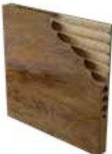
B. Płyta wiórowo-otworowa
